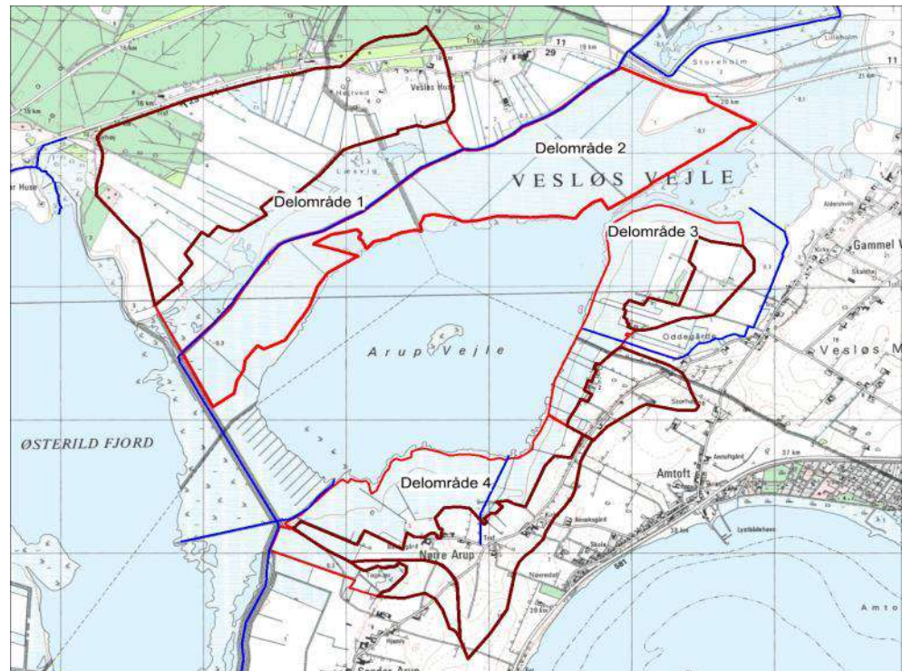
Figur 52: Afstrømningsoplande (brun streg) til projektområdet (rød streg) ved Arup Vejle. Vandløb vist med blå streg.
